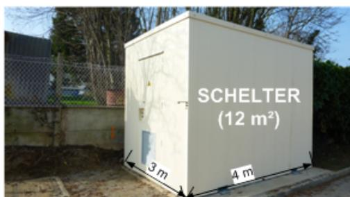
Figure 7 : Exemple de schelter de 12 m2 pour NRO
